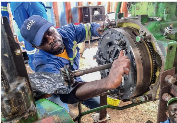
Links: Die Kuppelung des Traktors wird mit neuen Lamellen versehen
