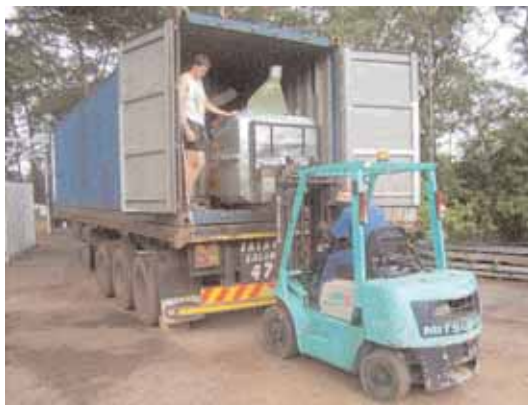
Seecontainer haben eine beachtliche Größe: Dieser ist 12 Meter lang, 2,35 Meter breit und 2,39 Meter hoch. Foto: Christian Conrad, Sambia
